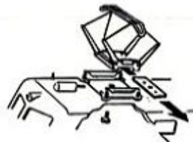
Haftreifenwechsel Changing traction tires Echange des bandages anti-dérapants
