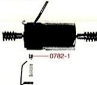
Kohlewechsel Replacing carbon brushes Changement des balais
